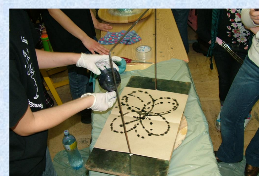
A mini Foucault-inga PET-palackkal, forgó tállal, maradandóan tintával, de újrafelhasználhatóan vízzel is rajzolja a „virágot” és a „csillagot”.
