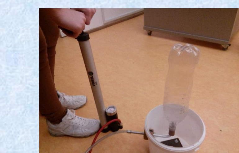
Beltérben csak levegővel megy 4-5 m magasra, kültéren 2-3 dl víz hozzáadásával akár 15 m-re is. Egy Yagi-antenna konzolja a hajlítót befűvöcsö.
