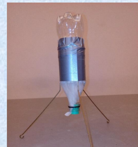
Ecetes rakéta. A papírszékendőre csomagolt szódabikarbóna jelenti a késleltetést.
