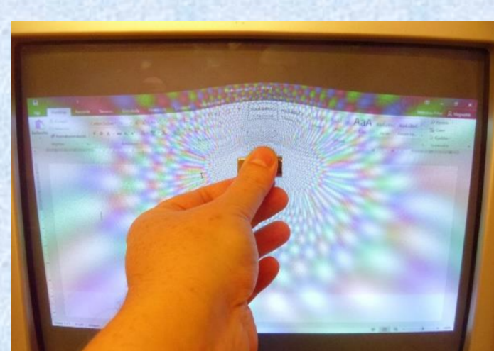
A sarki fény működésének modellje elektroncsöves képcsővel és Nd-mágnissal.
