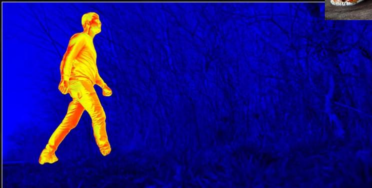
sieht Infrarotstrahlen mit  $\Delta T = 10 \text{ mK}$  Temperaturauflösung
