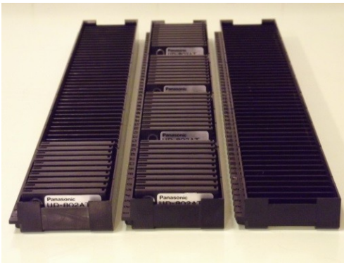
5. ábra: Panasonic UD-740 típusú rekeszes táruk, amelyekbe előzetesen bele kell helyezni a TLD-ket az automata kiolvasó, illetve besugárzó készülékkel történő feldolgozáshoz.
