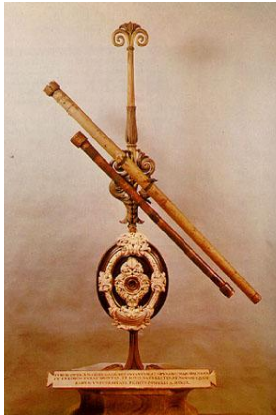
A firenzei múzeumban őrzött ikertávcsöve. Az objektív átmérője három centiméteres volt. Fényerejük pedig szerény mértékű.
