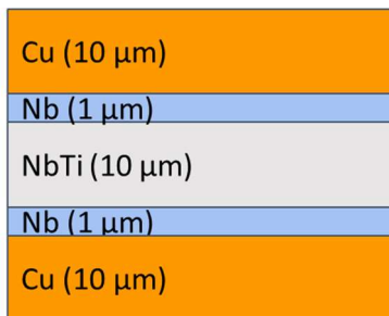
1. ábra - Szupravezető fémkompozit 1 szekvenciájának rétegrendje, a rétegek jellemző vastagságával
