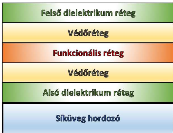
5. ábra: Tipikus "Low-E" rétegszerkezet sematikus felépítése
