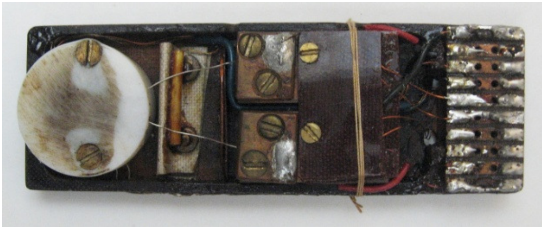
30. ábra. A termofeszültség mérése 0-300K között, a megfelelő hőmérsékletkülönbség beállításával és mérésével. Az egész mérőfej mozgatható módon megfelelő Cu tömbben volt elhelyezve a folyékony He-ot tartalmazó kriosztát gázterében, változtatható T hőmérsékleten, amit termoelemek mértek, ahogy \Delta T -t is. (Az elektromos ellenállásokat hasonló befogóban mértem 10 párhuzamosan felforrasztott mintán.). A 30. ábrán látható befogóban mértem a termofeszültségek, \Delta S(T) , hőmérsékletfüggését, mint azok a 31. ábrán láthatók [25]:
