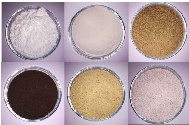
1.ábra. Az alkalmazott alap- és töltőanyagokBalról jobbra haladva: burgonyakeményítő (Haas), zeolit, burgonyahéj, kávézacc, tölgyfaliszt, tojánhéj
