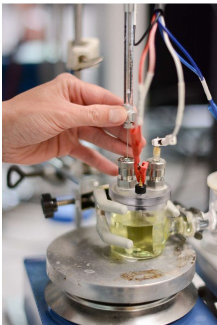
1. fotó : Mintavétel gáztömör fecskendővel lezárt oxigéntermelő cella gázteréből
