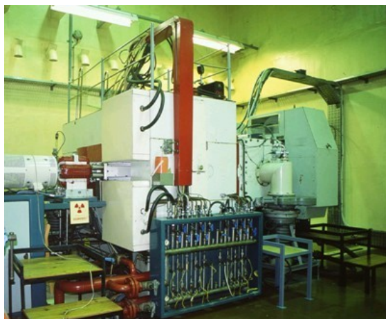
24.7. fénykép. Az MTA Atommagkutató Intézet MGC–20E izokrón ciklotronja Előtérben a 103 cm pólusátmérőjű elektromágnes (0,7–1,4 T), oldalt hátul a nagyfrekvenciás rezonátor (8 – 24 MHz). U = 20 - 30 kV.
