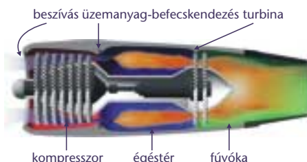
1. ábra. Egy gázturbina-hajtómű sematikus képe
