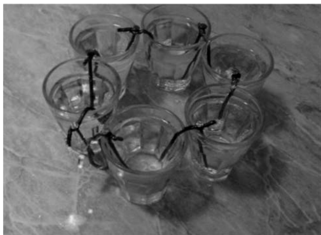
1. ábra. A hat darab elkülönülő, sorba kötött cella.
