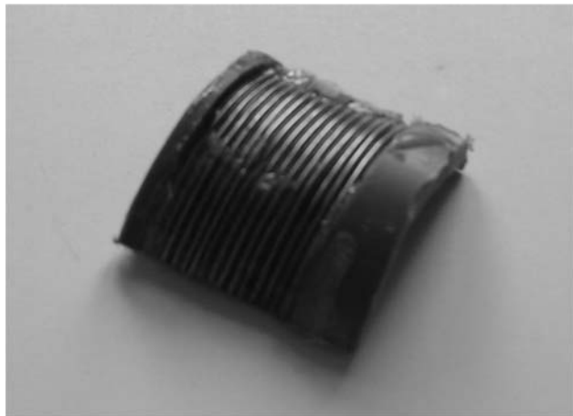
3. ábra. Párhuzamosan futó, vékony szálakkal történő kialakítás.
